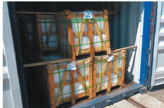
**Abbildung 9 Beispiele von Holzverpackungen, die nicht ISPM15 konform waren (Markierung nicht konform oder unlesbar) und auf Nematoden untersucht wurden. Bei beiden Objekten wurden keine Nematoden gefunden (Fotos: C. Hagmann).**
