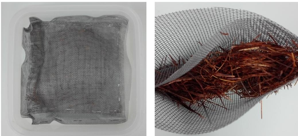
**Abbildung 6 Links: Baiting-Schale mit Netz. Rechts: Angepasstes, Doppelmaschiges Netz mit Lärchennadeln (Fotos: D. Rüegg).**
